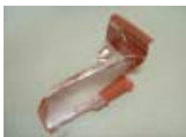
写真12) 弁当箱の破片 PEコーティングが はがれかけている
